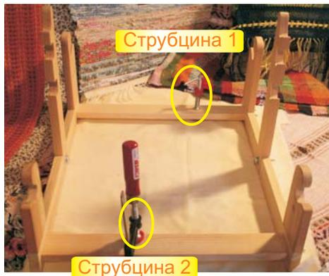
Закрепите 2 (или более) струбцины на станине, как показано на фото.
