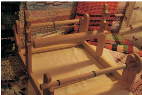
Установить на станину станка валы с привязанными планочками. На вертикальных стойках для бёрда устанавливается колода (в нижнее положение).
